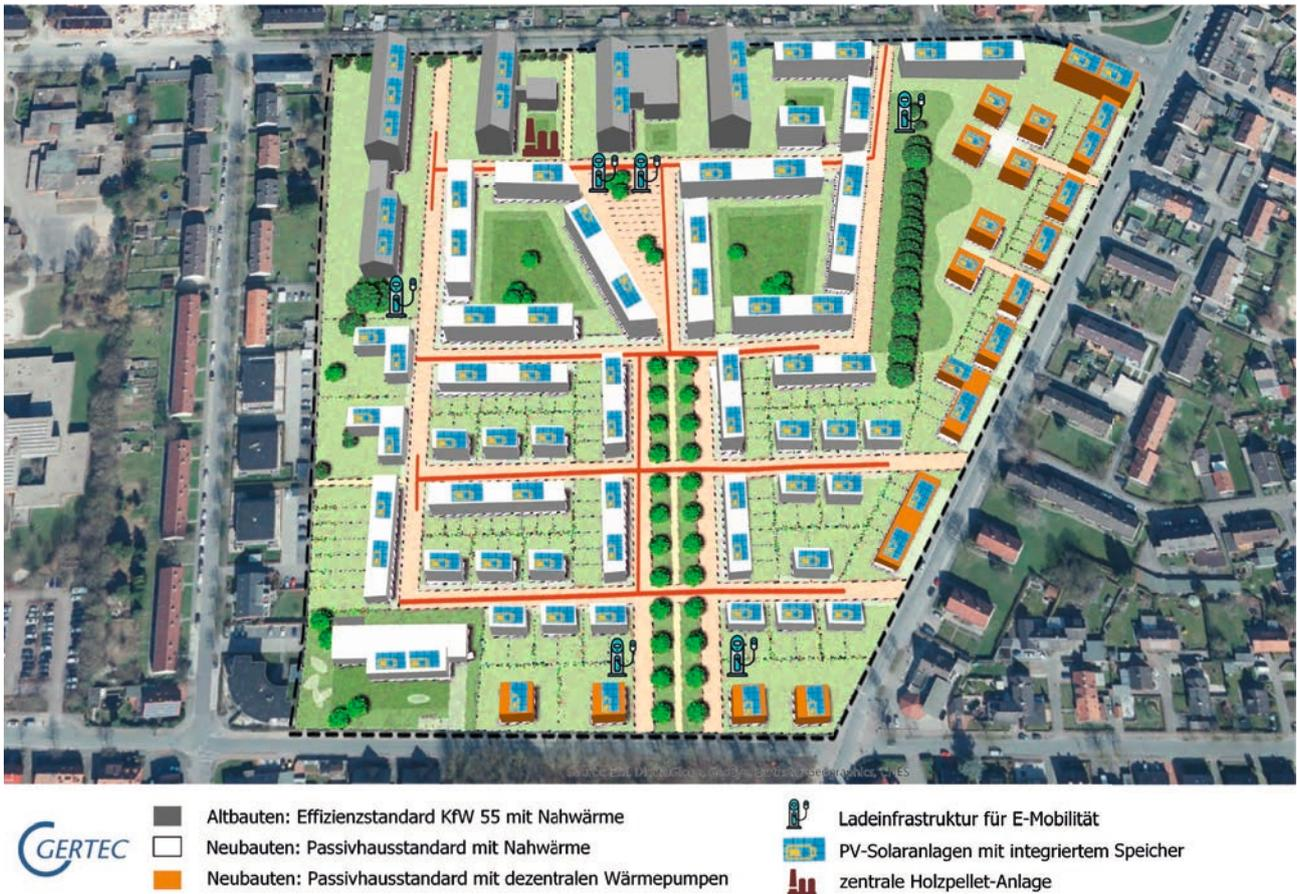
Abb. 03: Beispielhafte Übersicht der Effizienzstandards und Energieversorgung im Szenario 2<sup>61</sup>
