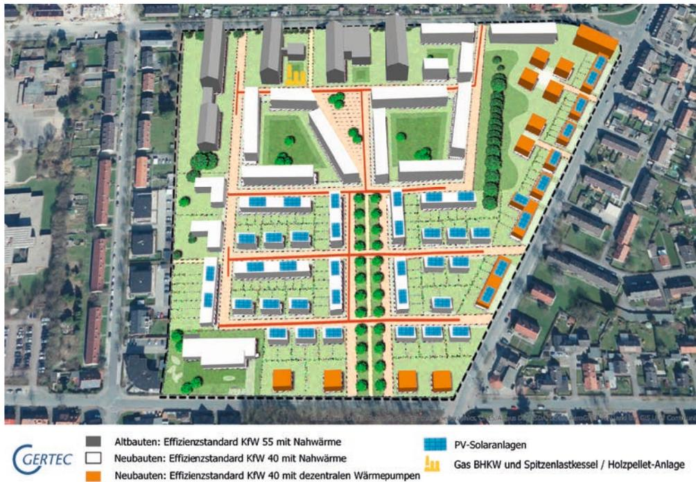
Abb. 81: Übersicht der Effizienzstandards und Energieversorgung im Szenario 1 <sup>61</sup>
