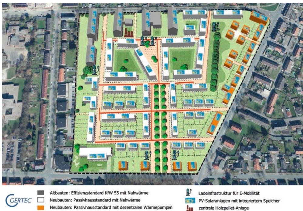
Abb. 82: Übersicht der Effizienzstandards und Energieversorgung im Szenario 2 <sup>61</sup>
