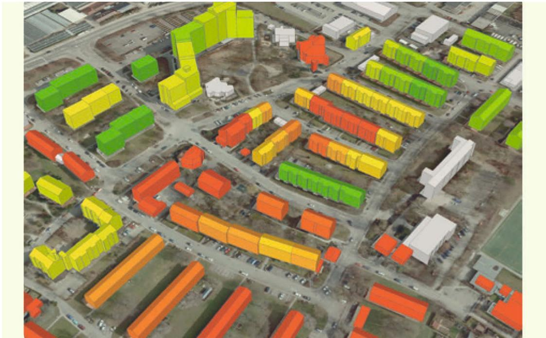
Abb. 136: Simulierter Jahresheizwärmebedarf im 3D-Stadtmodell Grünbühl <sup>177</sup>
