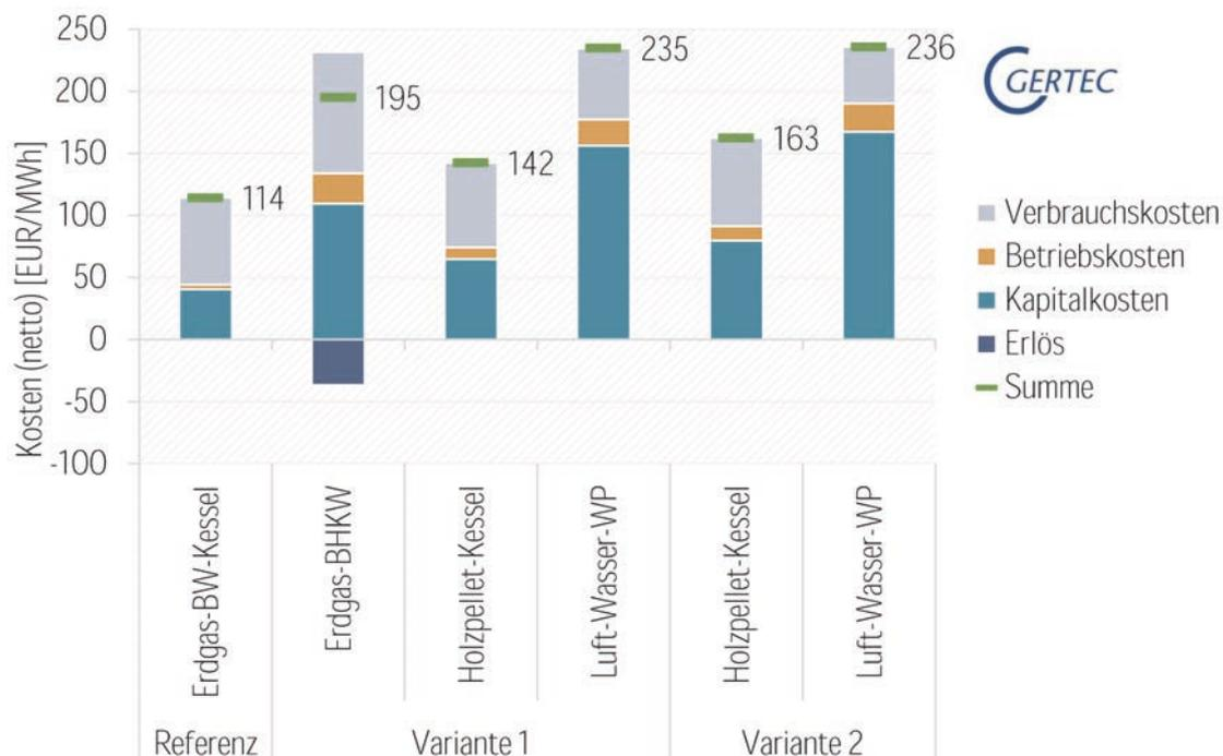
Abb. 89: Vergleich der Kosten unterschiedlicher Wärmeversorgungssysteme <sup>55</sup>
